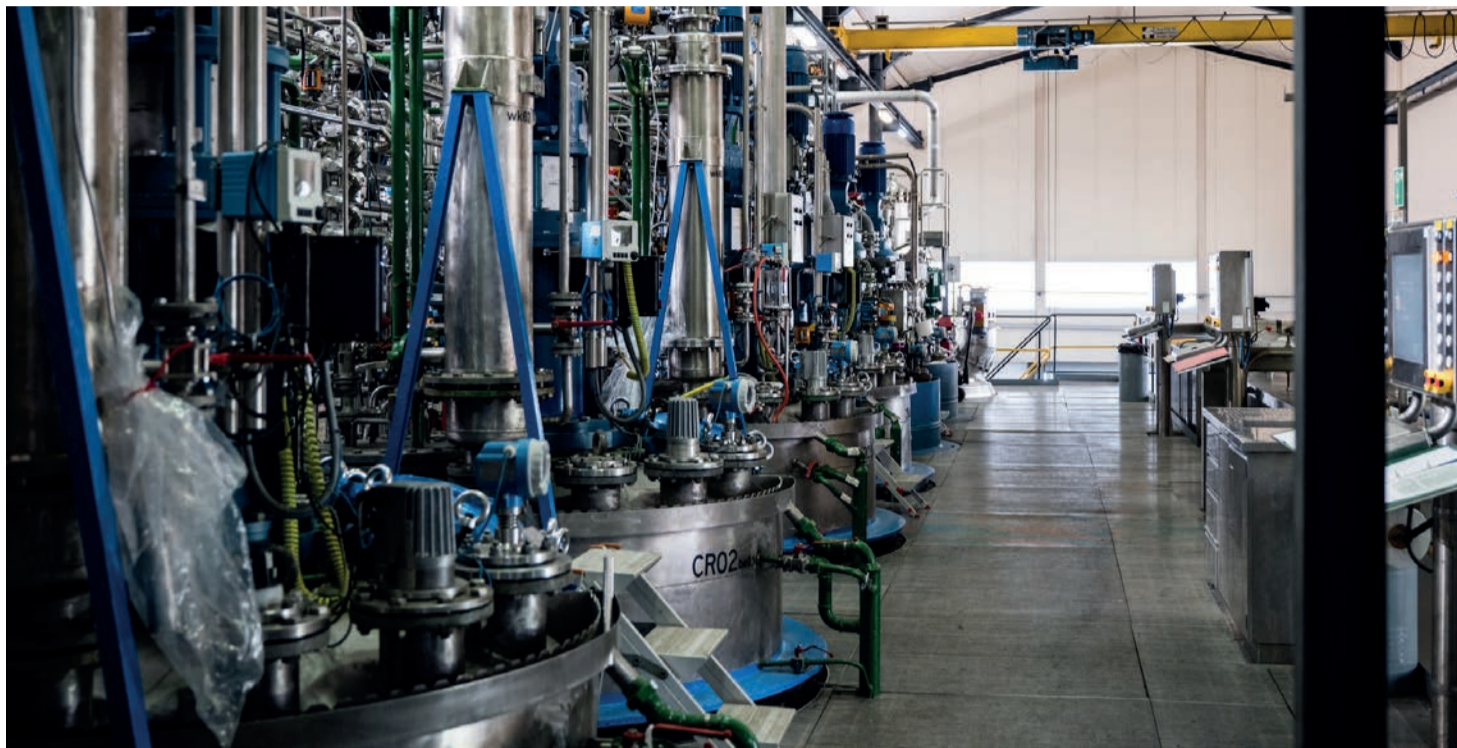
Valsynthese produziert jährlich über 1000 Tonnen Feinchemikalien, die in 27 Reaktoren in Gamsen hergestellt werden.
